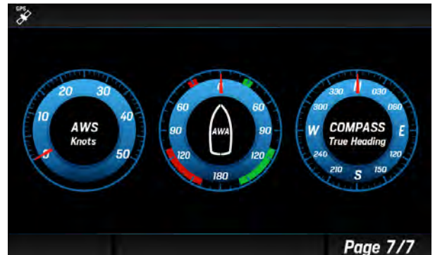
Layout NAV DASH : Layout mit zwei, drei oder acht konfigurierbaren analogen Anzeigen (siehe "Im Layout Nav Dash anzeigbare Daten" unten)
