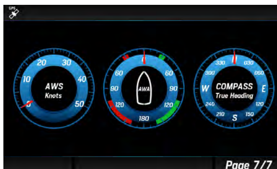
Layout NAV DASH : layout a due, tre o otto indicatori analogici configurabili (vedi "Dati visualizzabili nel layout Nav Dash" nel seguito)
