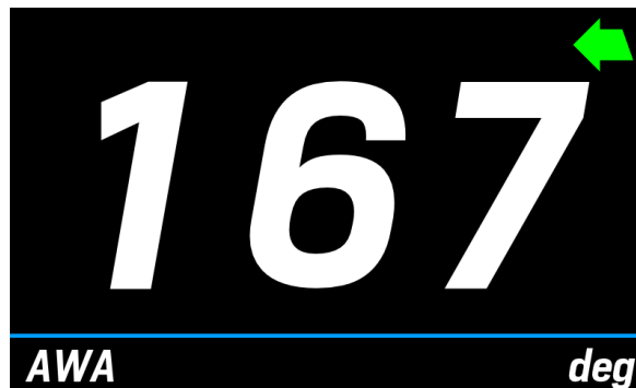
Layout MAST : vier Seiten mit folgenden Daten: Scheinbarer Windwinkel (AWA) , Scheinbare Windgeschwindigkeit (AWS) , Geschwindigkeit durch Wasser (STW) , Rechtweisender Steuerkurs (true heading) .
