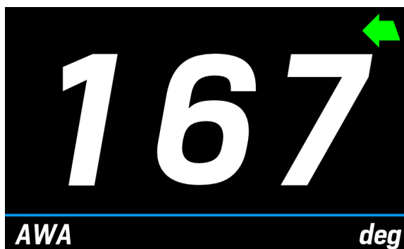
Layout MAST : quattro pagine con i dati relativi a: Angolo vento apparente (AWA) , Velocità vento apparente (AWS) , Velocità attraverso l'acqua (STW) , Prora reale (true heading) .
