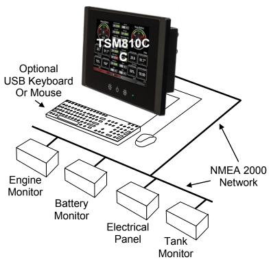
Figure 1 – TSM810C Network Diagram
